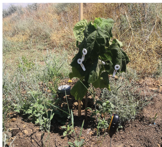
Рисунок 6. Измерение флуоресценции хлорофилла листьев саженца павловнии на Полигоне захоронения отходов АО «ВТЗ» с помощью Handy PEA+ (Hansatech Instruments, UK)
