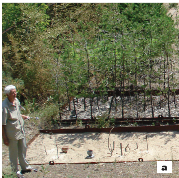
Рисунок 2. Крупногабаритные лизиметры гидрологического комплекса ФНЦ агроэкологии РАН: а) лизиметры заполнены почвенными субстратами различного гранулометрического состава; б) все лизиметры имеют водовыпуск в подземную галерею
