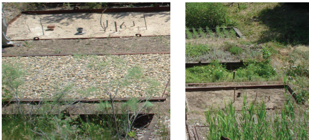
Рис. 2,3 – Лизиметрические модели гидрологического комплекса ФНЦ агроэкологии РАН
