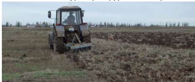
Чизелевание почвы орудием ОЧО-5-40, 2016 г.
