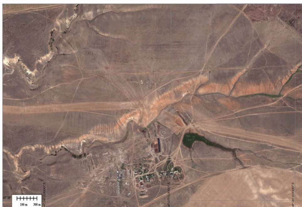
Рисунок 2. Линейная эрозия склонов водосбора р. Мышкова
